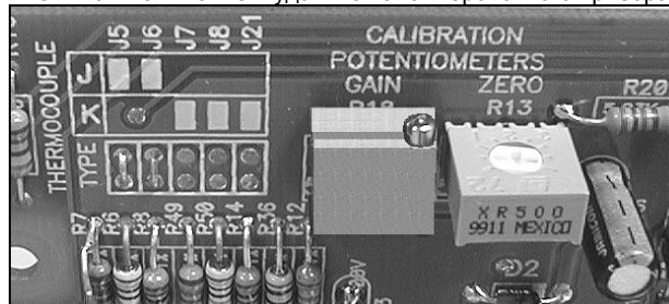
Рисунок 6 – Калибровочные резисторы переменного сопротивления (потенциометры)
