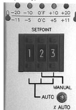
Рисунок 2 – Кнопка переключения режимов (авто/ручной)
